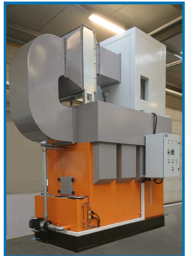
LGP-NÓVUM 12000 típ. berendezés: extrudálóktól elszívott páras és poros levegő tisztítására
