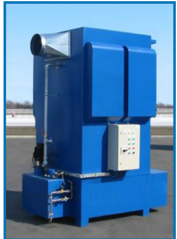
LGP-NÓVUM 6000: nagyteljesítményű csiszolás során keletkező acélpór, emulzió leválasztására
